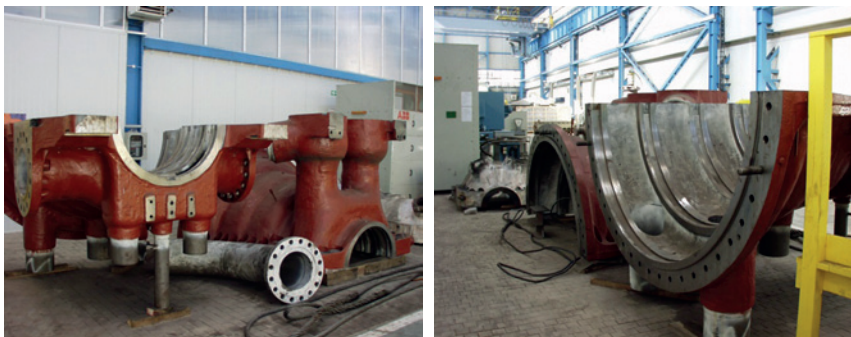
Rys. 13. Kadłub turbiny typu 200 MW po remoncie i rewitalizacji
